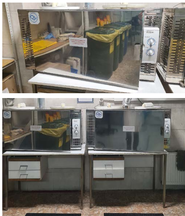
Рис. 7. Установки YOMO-01/150 «О-ЦНТ» для аппаратного обеззараживания медицинских отходов волнами сверхвысокой частоты
